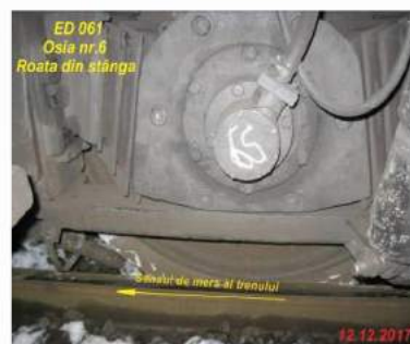
Foto nr.7 - Roata din stânga osiei nr.6 în poziție deraiată în interiorul căii
