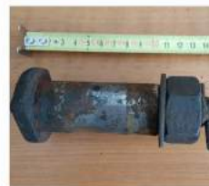
Imaginea 11 – ansamblu bolt, șplint, piuliță și șaibă de la capul barei de frână (reconstituire)
