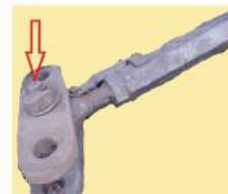
Imaginea 10 – bolt, șplint, piuliță și șaibă montate la capul barei de frână (reconstituire)
