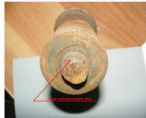
Imaginea 14 – bulonul (bolțul) de la timoniera de frână al locomotivei EA 314, rupt la data de 29.11.2015 (extras din Raportul de investigare)
