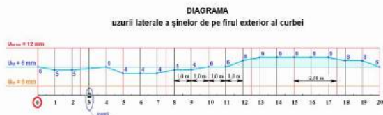
Figura nr.3 – Uzura laterală a șinelor de pe firul exterior al curbei
