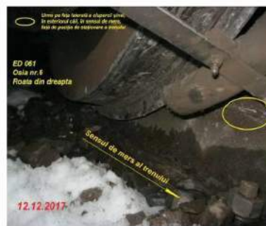
Foto nr.6 - Urme de deraiere în sensul de mers pe cca. 8,00 m de la locomotivă
