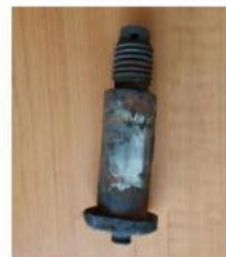
Imaginea 13 – bolțul de la capul barei de frână al locomotivei DA1356 (reconstituire)
