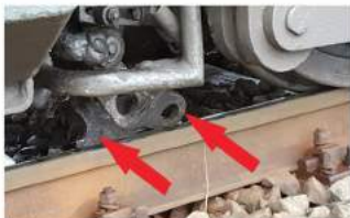
Imaginea 9 – piese metalice deformate din cauza smulgerii barei de frână, la locomotiva DA 1356
