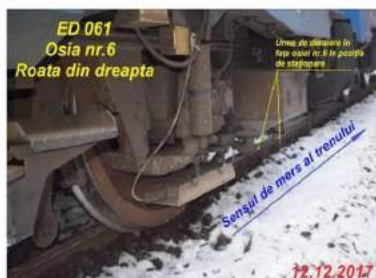
Foto nr.4 - Roata din dreapta osiei nr.6 în poziție deraiată în exteriorul căii. Urme de deraiere în sensul de mers al trenului față de poziția de staționare.
