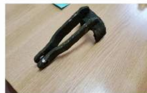
Imaginea 8 – piesă metalică desprinsă de la bara de frână, a locomotivei DA 1356
